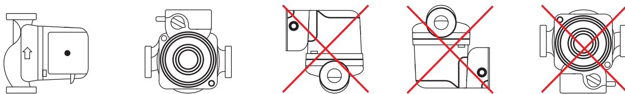
Варианты установки циркуляционных электронасосов с «мокрым» ротором
